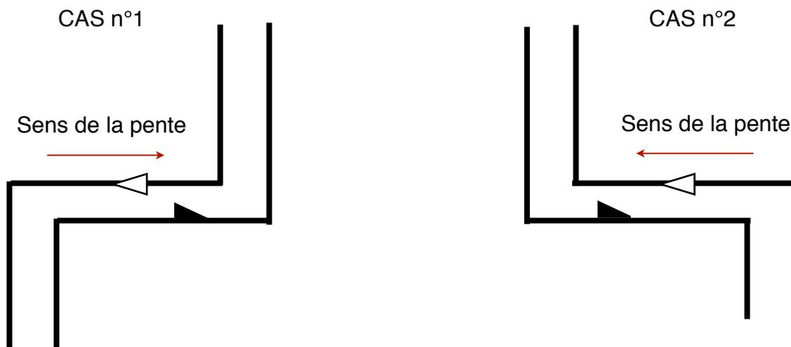
La pente d'une installation est de 1 à 2 millimètres par mètre
