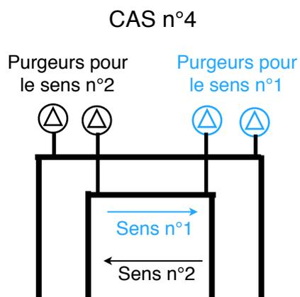
Si possible éviter ce cas. Si cela est inévitable il sera alors nécessaire de poser des purgeurs automatique pour chacun des tuyaux.
