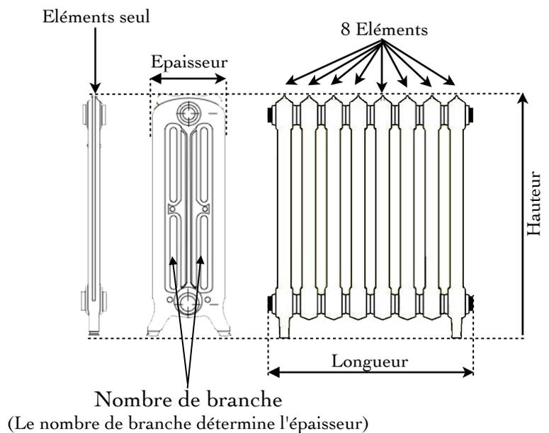
Pour déterminer les dimensions d'un radiateur fonte, il faut tout simplement mesurer, sur plan ou physiquement, l'emplacement définit pour ce dernier.
