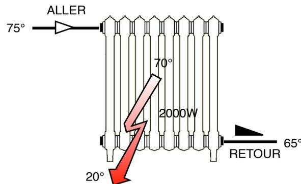
On définit  $\Delta T = ((\text{Température d'entrée de l'eau} + \text{Température de sortie de l'eau}) / 2) - \text{Température de confort ambiante}$  (formule simplifiée)
